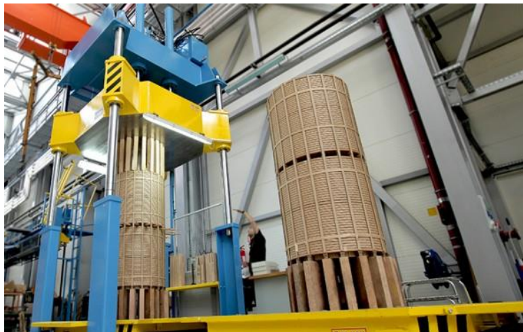
Рис. 1. Пресс, используемый для опрессовки обмоток трансформатора.
