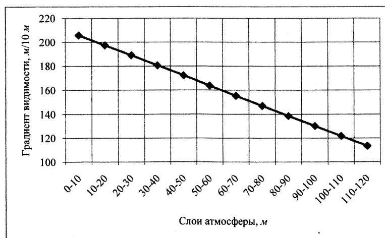
Рис. 3. Зависимость градиента дальности видимости от высоты в подоблачном слое при адвективном процессе (120×2000)
