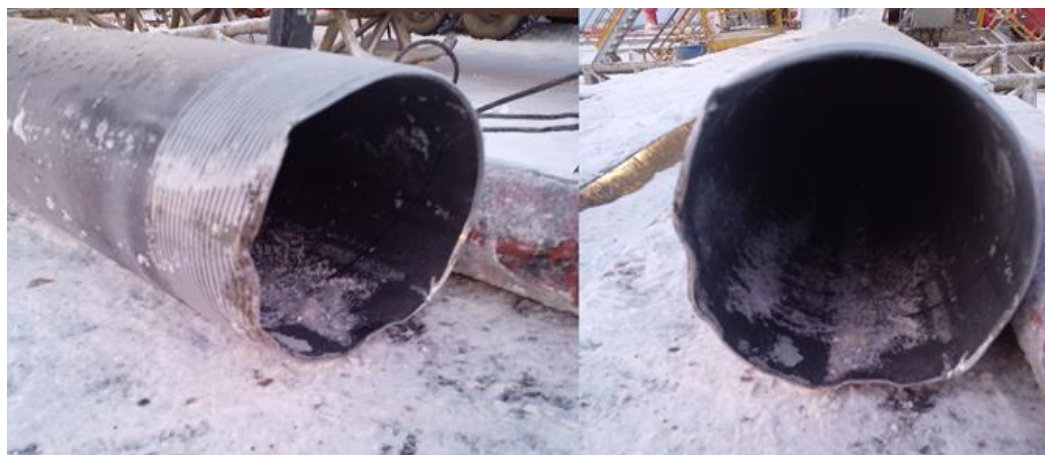
Рис. 2 – Фото деформированной трубы [1]
