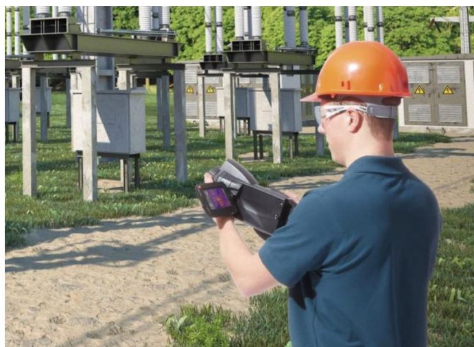
Рис. 3. Применение тепловизора «Testo» для снятия термограммы токового контура
