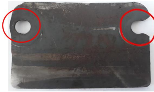
Рисунок 3 – Деформация и излом проушины цепи
