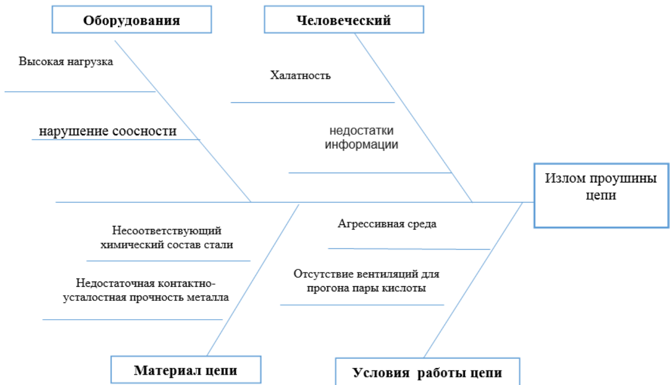
Рисунок 1 – Диаграмма Исикавы для дефекта «Излом проушины цепи»
