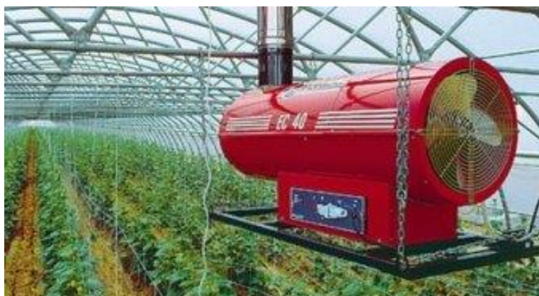
Рисунок 2 - Пример размещения тепловой пушки в помещении
