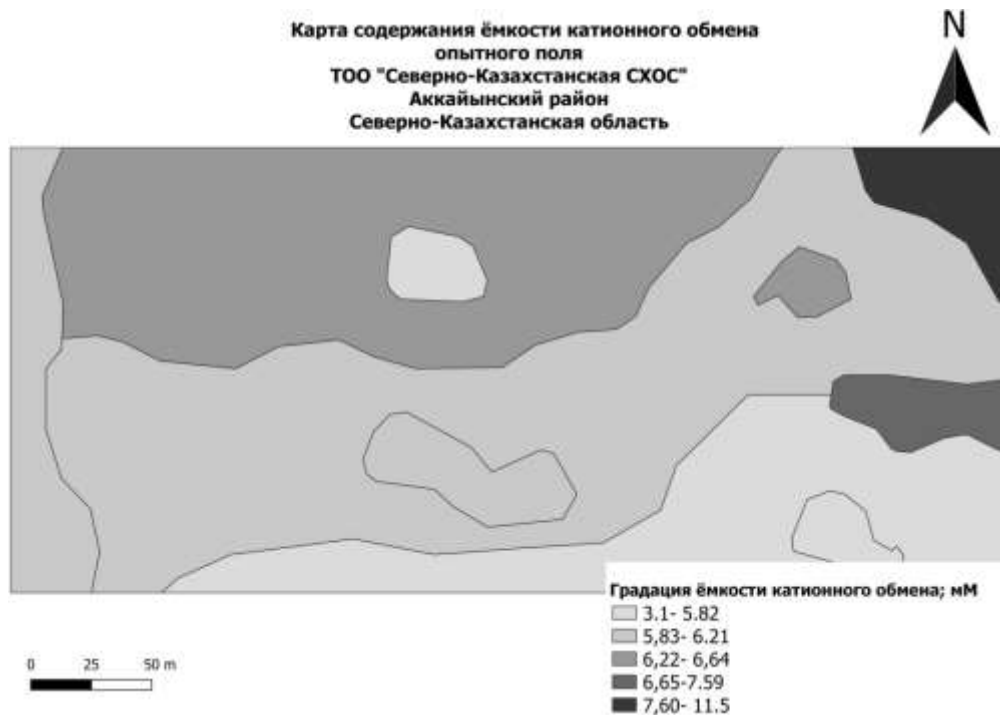
Рисунок 10 – Карта содержания емкости катионного обмена, полученная методом электропроводимости.
