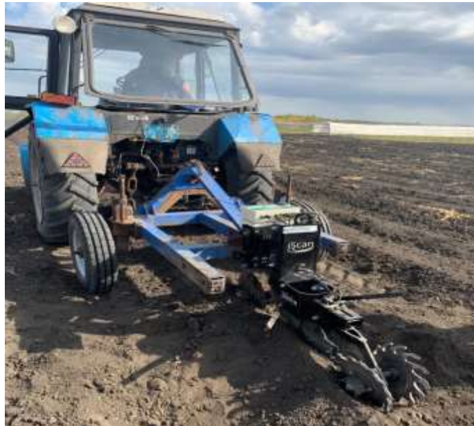
Рисунок 3. Сканирование почвы сканером VerisIScan.
