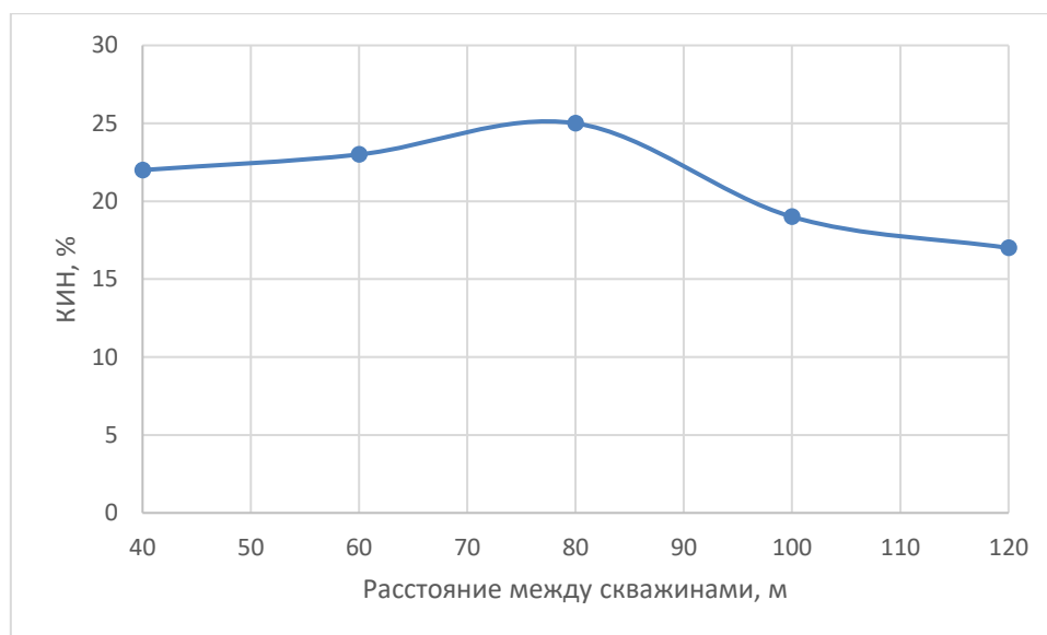
Рисунок 4 – График зависимости КИН от расстояния между скважинами
