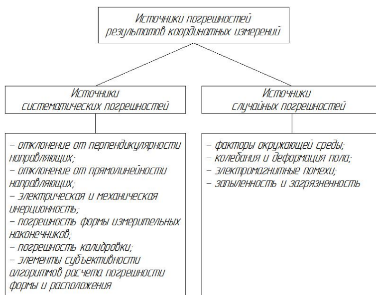
Рис. 1. Классификация составляющих погрешностей координатных измерений
