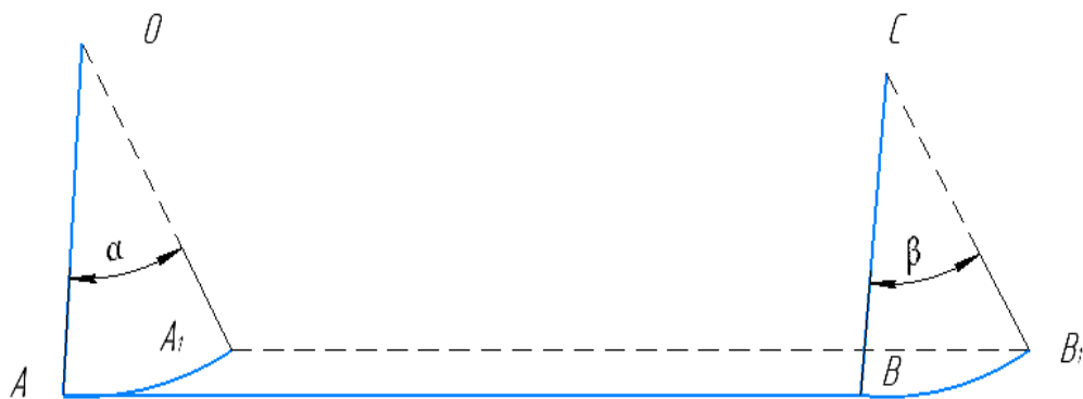
Рисунок 2. Кинематическая схема привода управления ТНВД.
