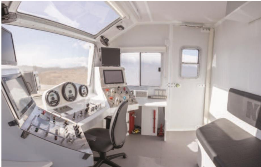
Рис. 1. Общий вид центра управления установкой ГНКТ повышенной грузоподъемности (NOV) 2 3/8"
