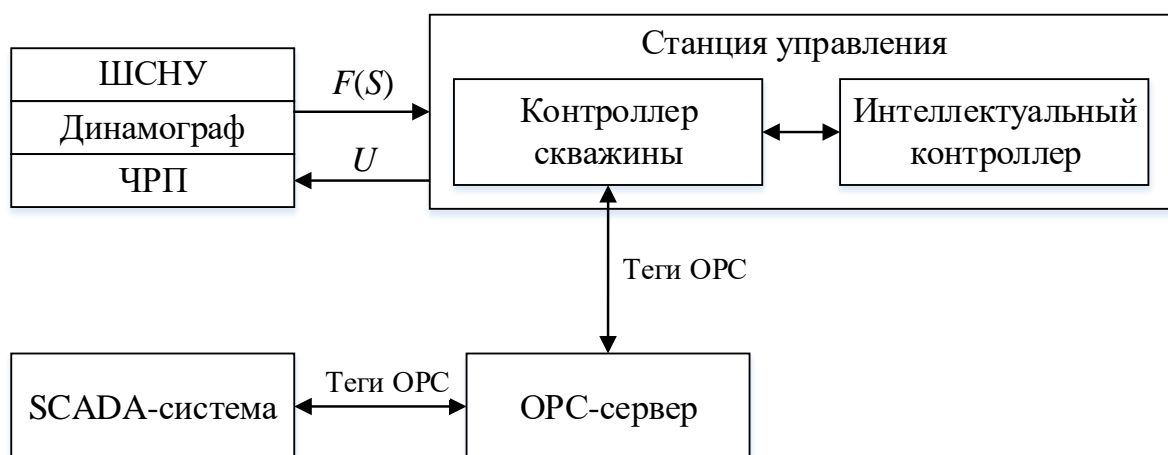
Рисунок 1 – Схема управления ШСНУ с использованием OPC -технологии
