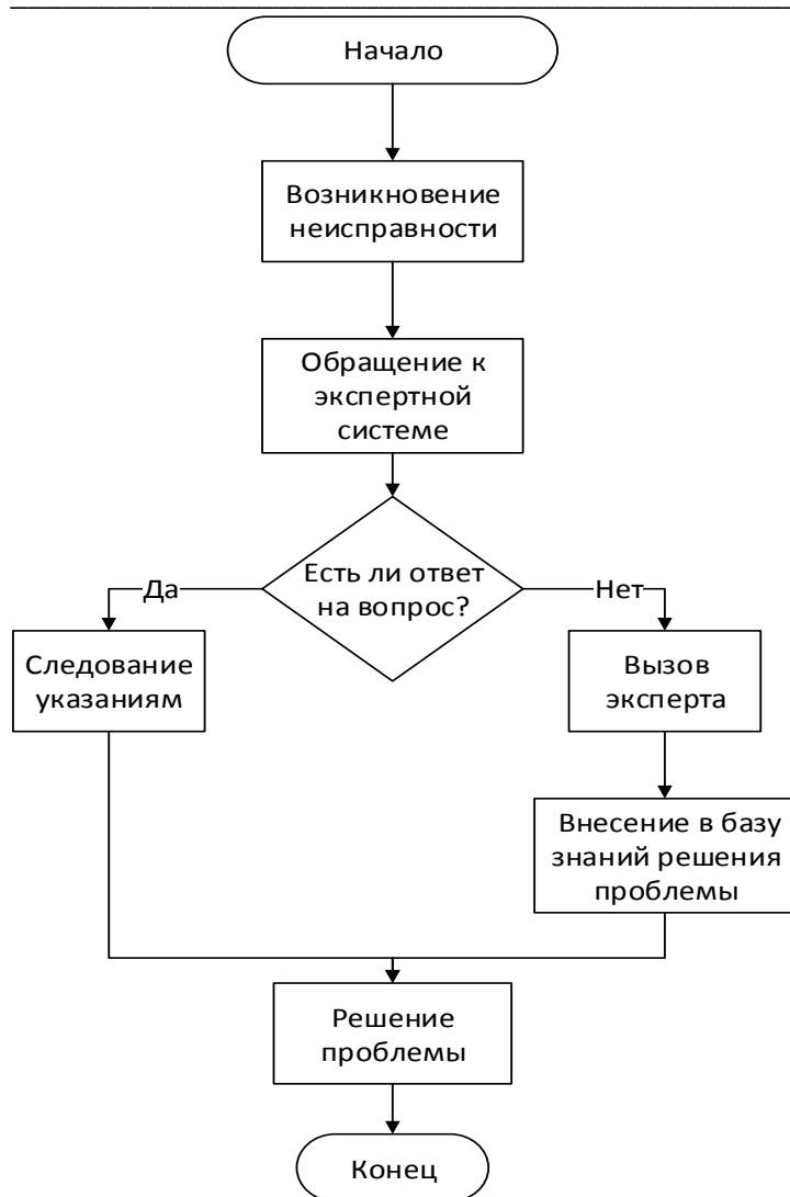
Рис. 2. Предлагаемая схема устранения неполадок
