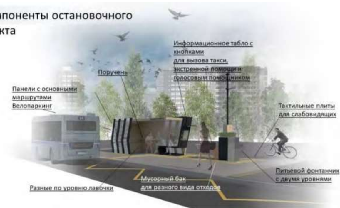
Рис. 3. Обустройство автобусных остановок
