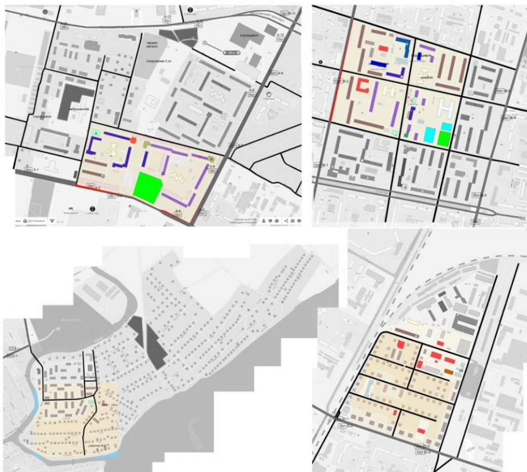
Рисунок 1 – Морфотипы А, В, С, D слева направо; квадратами выделены зоны расчета программным комплексом ENVI-metLite
