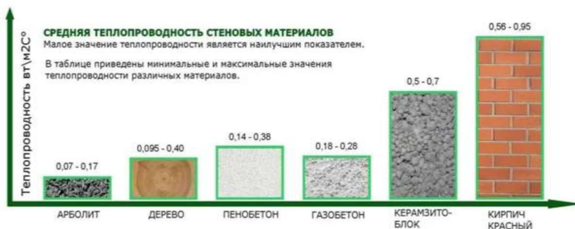
Рис. 2 Сравнение теплопроводности арболита с другими материалами.
