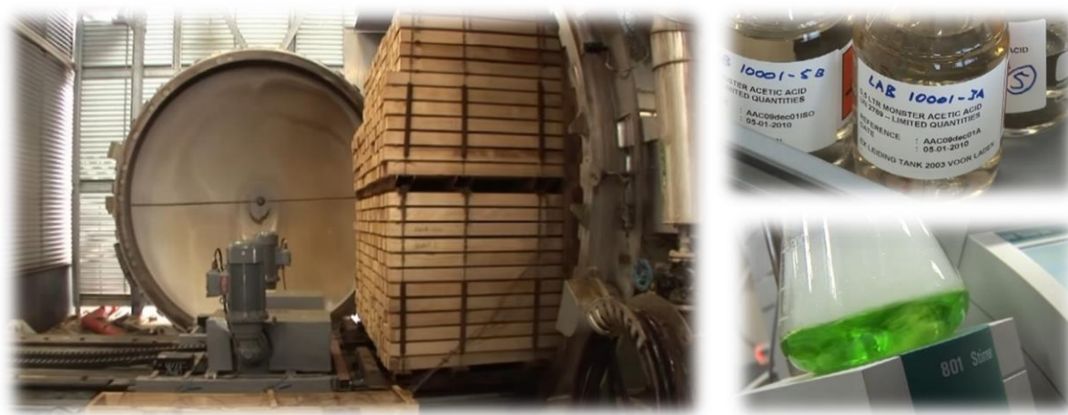
Рисунок 4 - Процесс Ацетилирования древесины
