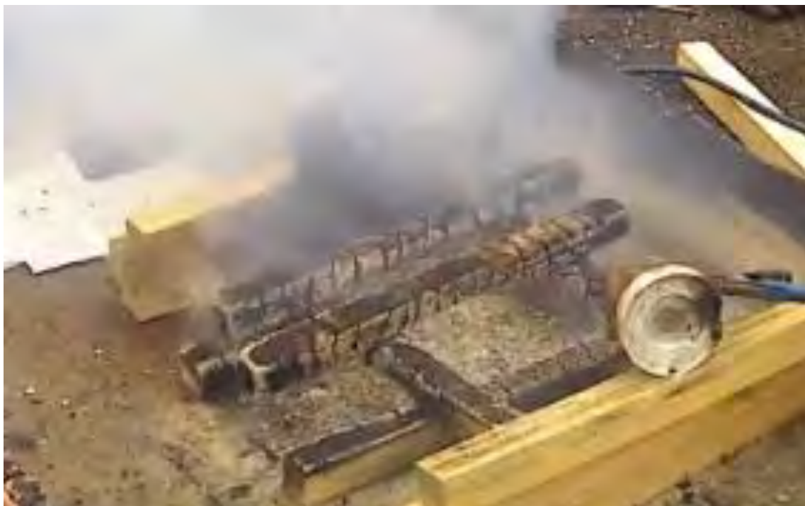
Рисунок №3. Тушение модельного очага пожара класса А, размерами 500x350x350 мм в первом исследовании.
