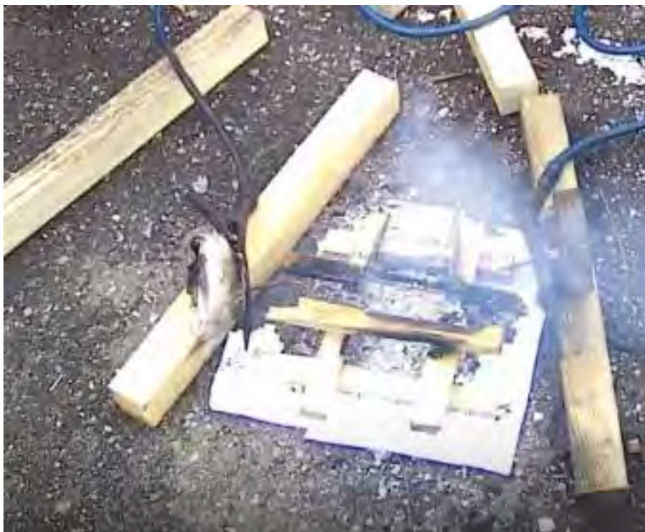
Рисунок №7. Тушение модельного очага пожара размерами 300x150x210 мм во втором исследовании.
