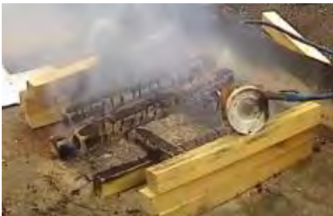
Рисунок №4. Тушение модельного очага пожара класса А, размерами 500x350x350 мм во втором исследовании.
