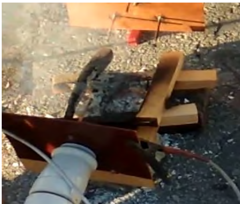
Рисунок №6. Тушение модельного очага пожара размерами 300x150x210 мм в первом исследовании.
