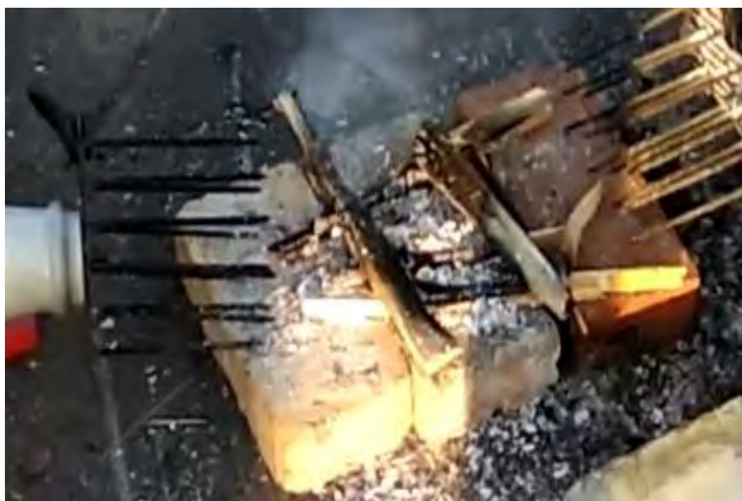
Рисунок №8. Тушение модельного очага пожара размерами 300x150x210 мм в третьем исследовании.
