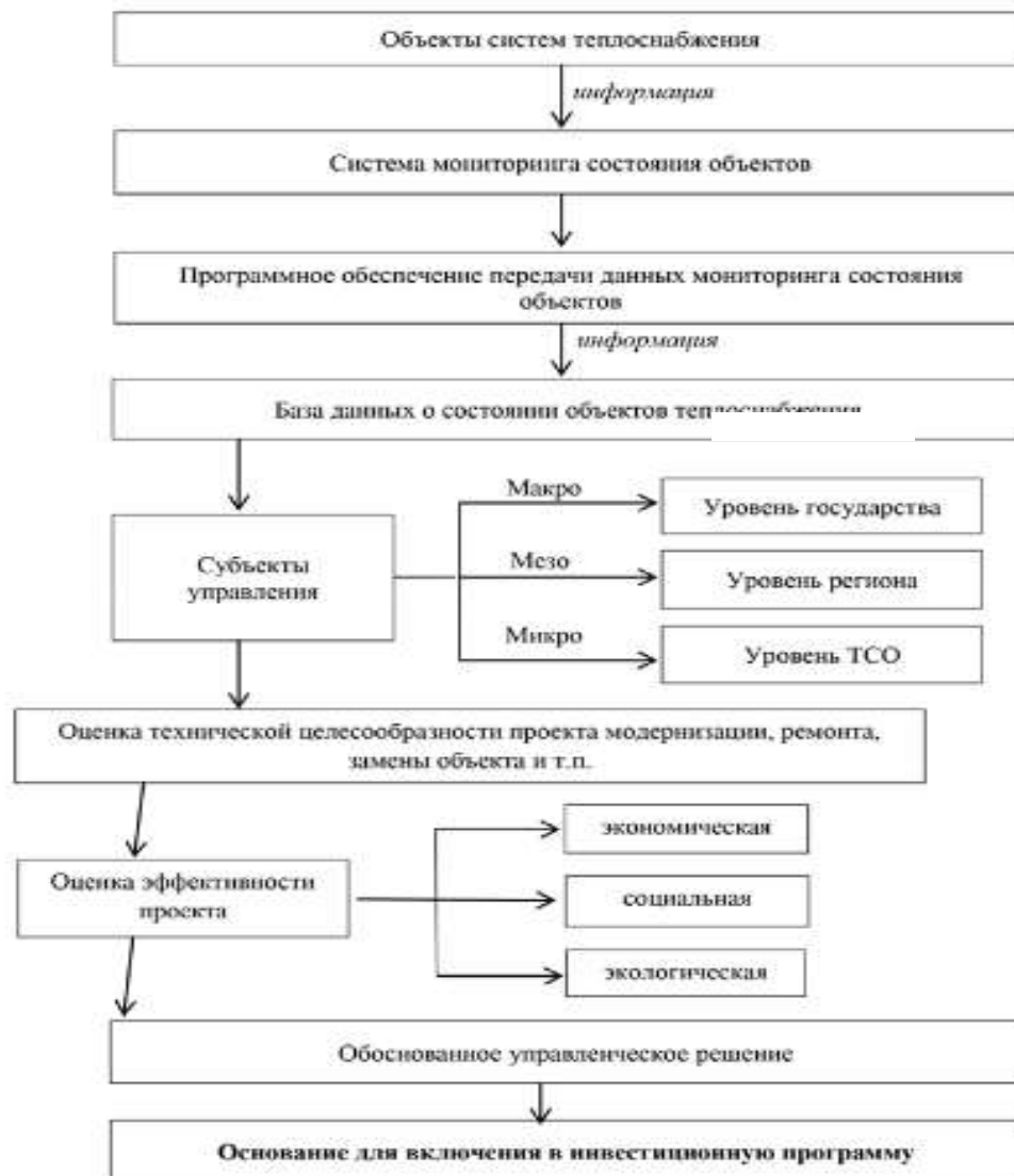
Рис. 1. Алгоритм принятия управленческого решения о включении объекта системы энергетики в инвестиционную программу на основе данных мониторинга состояния объекта.
