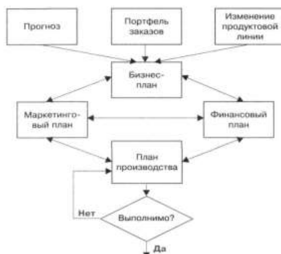
Рис.3. Схема системы MRP II
