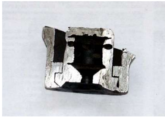
Рис.2. Эрозионный износ центробежной форсунки ВПО
