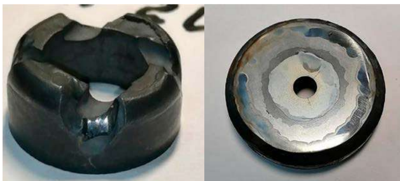
Рис.4. Эрозионный износ и трещины на центробежной форсунке ВПО
