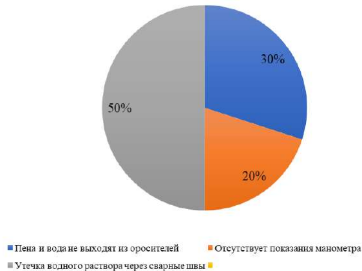
Рис.2 – Случаи нарушений в работе системы пожаротушения в 2019 г.
