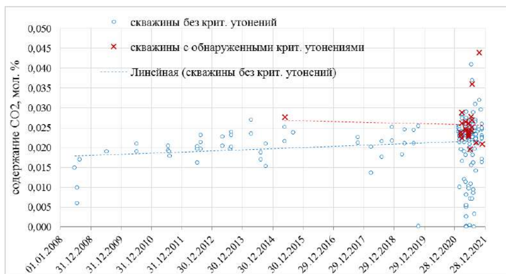
Рис. 5. Результаты лабораторного анализа проб сырого газа ( \text{CO}_2 ) со скважин за весь период наблюдений
