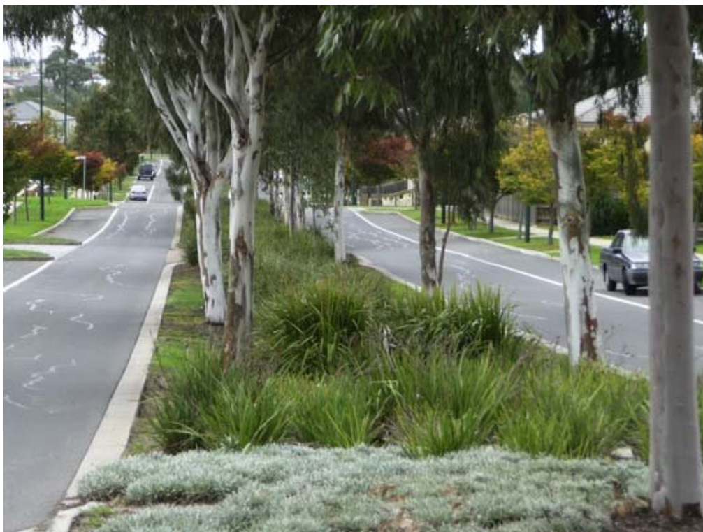
Рис.4. Траншея с системой биоудаления стоков
