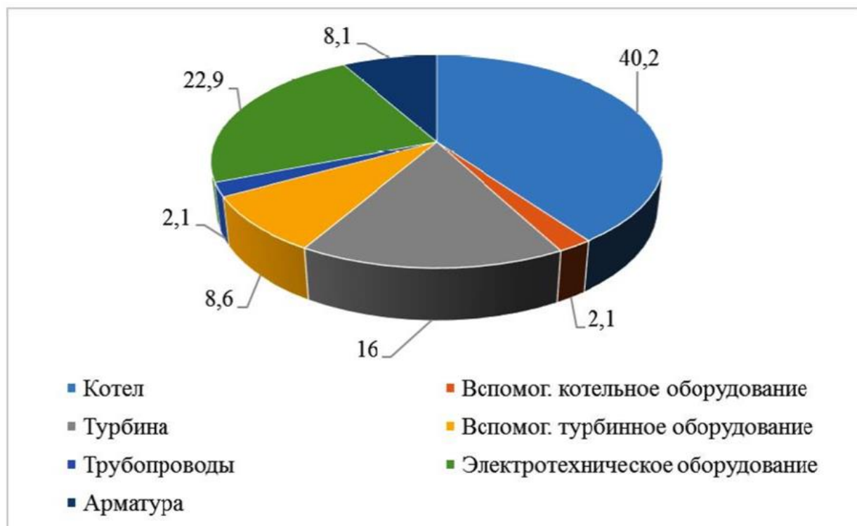
Рис. 4. Распределение отказов энергоблоков ТЭС по характерным видам оборудования.
