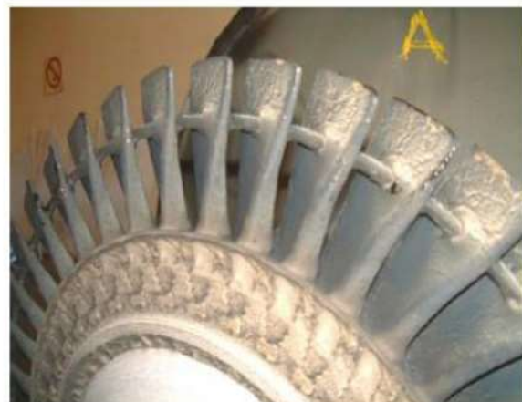
Турбина после 7000 часов работы с использованием присадки
