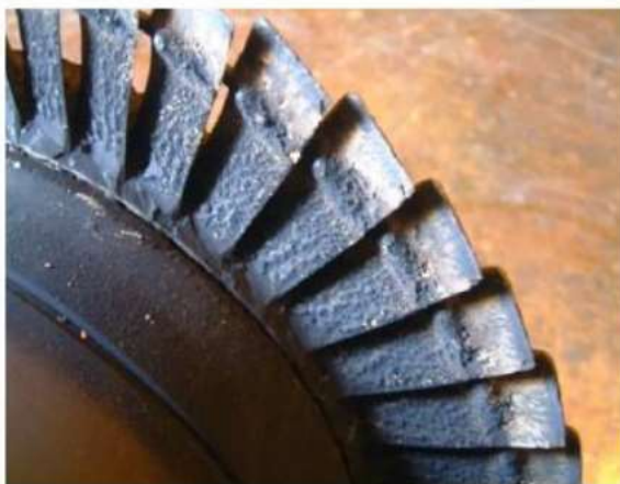
Турбина после 3000 часов работы, без использования присадки
