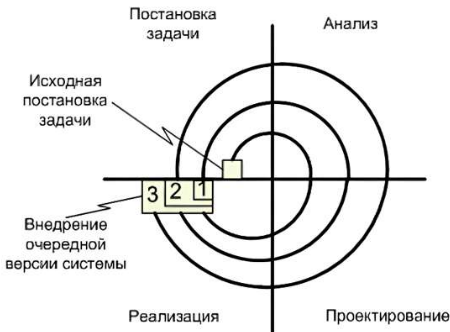
Рис. 3. Спиральная или итерационная схема разработки программного обеспечения.
