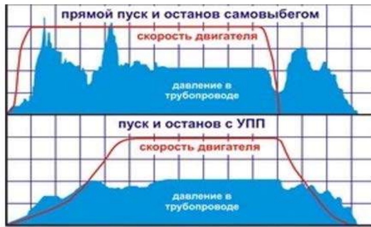
Рисунок 4. Изменение работы двигателя с использованием технологии «Плавный старт».
