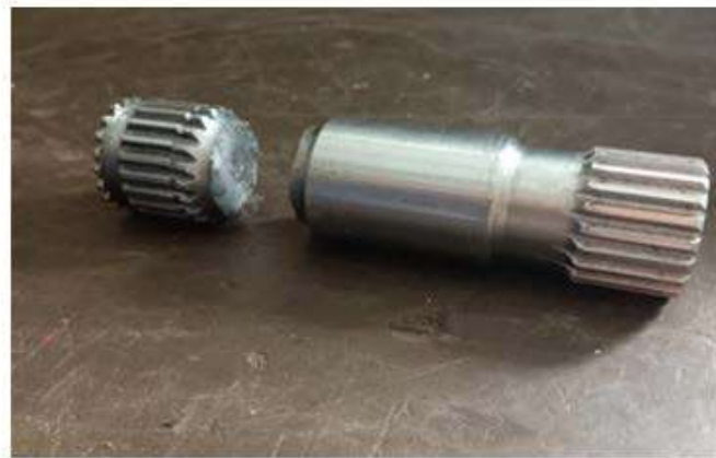
Рисунок 3. Сломанный вал из-за превышения мощности двигателя.
