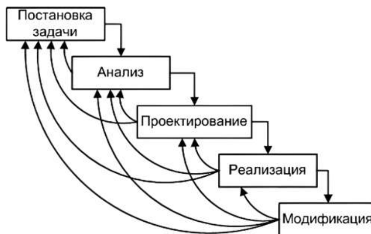
Рис. 2. Схема разработки программного обеспечения с промежуточным контролем.
