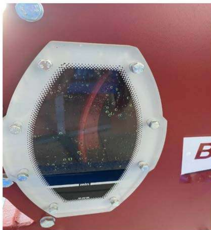
Рисунок 4. Окно для проверки уровня масла насоса.
