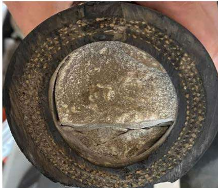
Рисунок 2. Рукав насоса с застывшим композитом.
