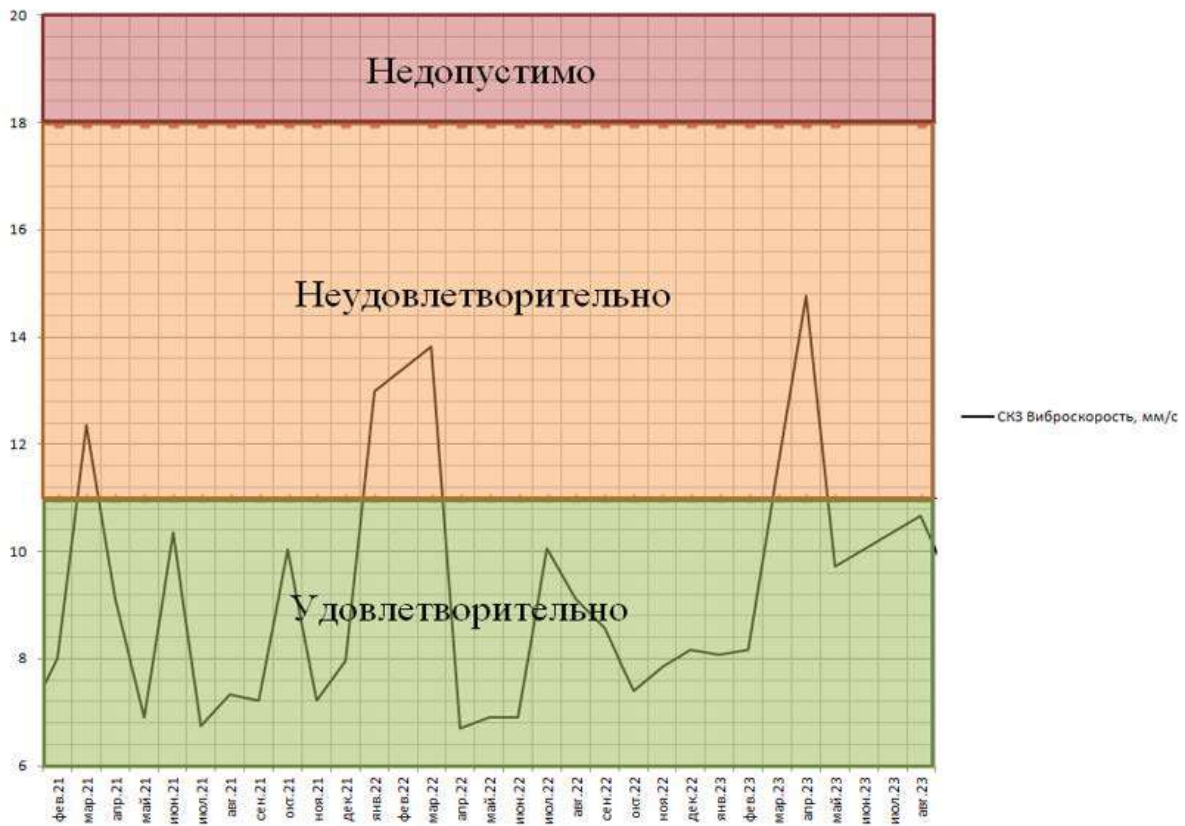
Рисунок 3. Виброскорость насоса на третьем подшипнике до изменения ТО.
