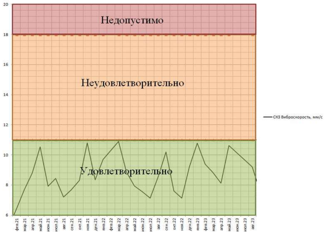
Рисунок 4. Виброскорость насоса на третьем подшипнике после изменения ТО.
