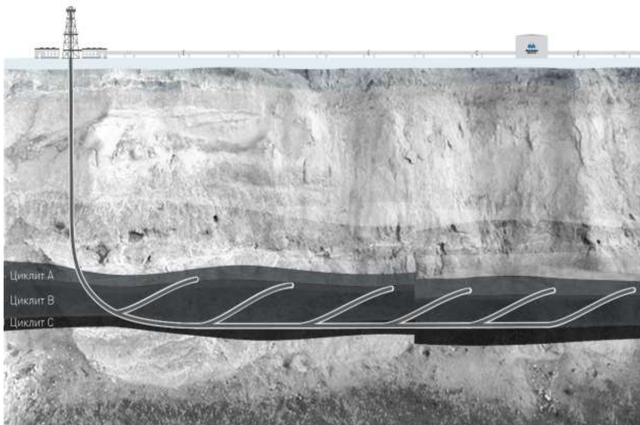
Рис. 1. Иллюстрация скважины, пробуренной по технологии Фишбон
