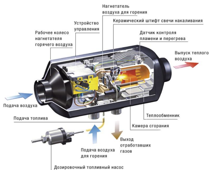
Рисунок 1. Принцип работы воздушного автономного отопителя
