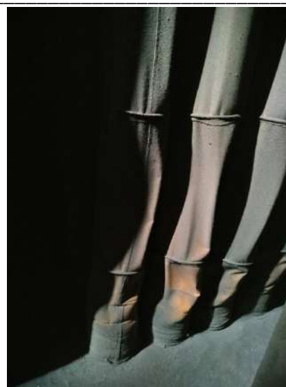
Рис. 3 – тканевый рукавный фильтр
