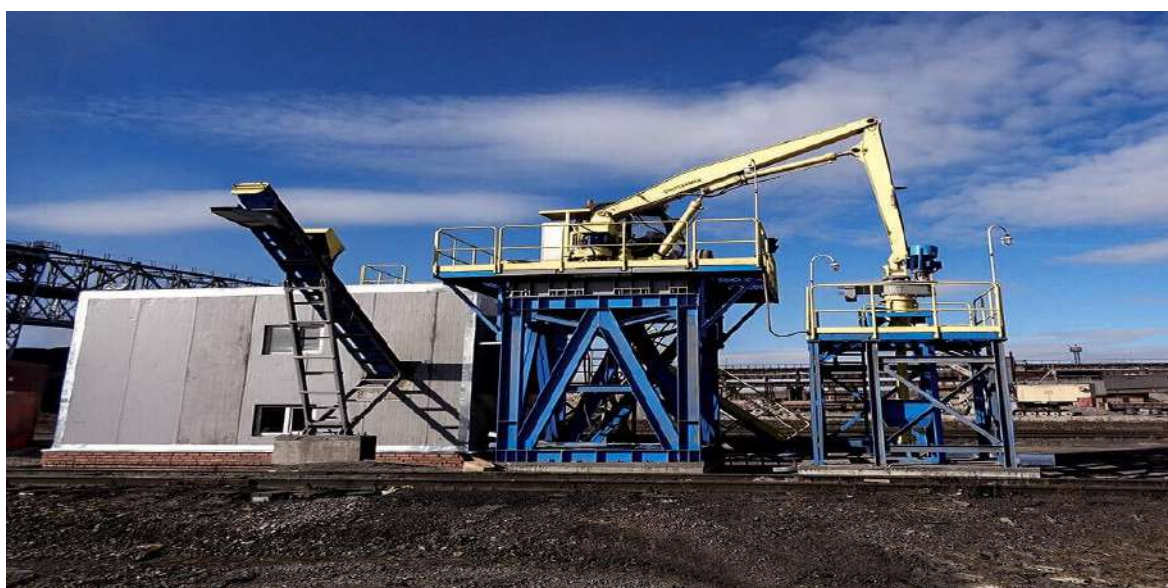
Рис.1. Пробоотборник буровой шнековый – ПБШ-150
