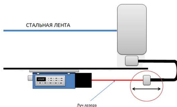
Рисунок 3. Система положения стальной ленты с лазерным дальномером
